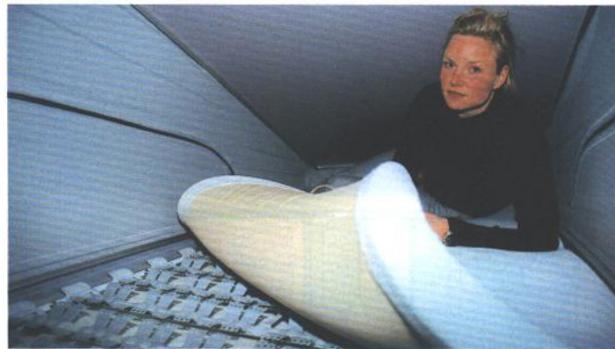
Oberklassekomfort im Campingbus: Unter der Matratze im aufklappbaren Dachgeschoss verbirgt sich eine punktelastische Federung.
