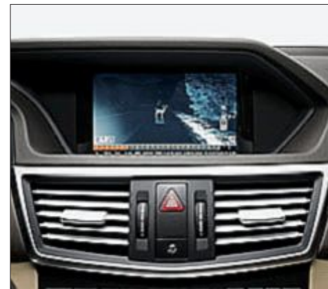
Night View Assist viser det opplyste området fra fjernlyset som et bilde i sentraldisplayet.
