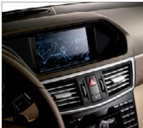
Multimedisystemet COMAND APS (tilleggsutstyr) kombinerer telefon, audio- og navigasjonssystem.
